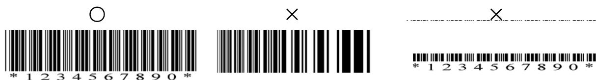
エレメント幅の不揃い (左側が細く、右側が太い)
